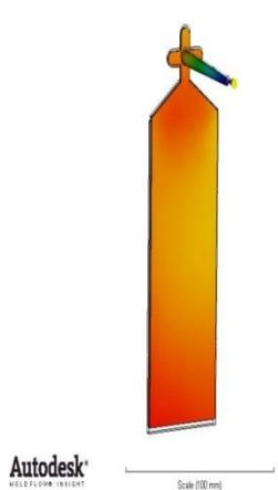
یکنواخت بودن میزان انقباض، قطعه معوج شد و به طور یکنواخت کوچک می گردد. در صورت انقباض غیر یکنواخت قسمت های مختلف قطعه تنفس ایجاد شد، بین قسمت های مختلف قطعه (را بسته به استحکام و چگونگی ماده)، موجب معوج شده قطعه و در صورت تشدید این وضعیت، موجب تک برداشت قطعه می گردد.
