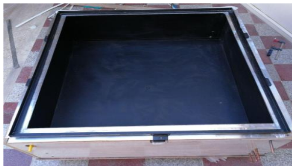
شکل ۱: حوضچه آب شور پس از رنگ آمیزی، عایق کاری و قرار گرفتن در باکس ام دی اف
