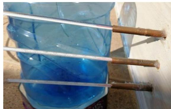
شکل ۵: دماستج‌های میله‌ای جهت اندازه‌گیری دمای آب شور در ارتفاعات مختلف
