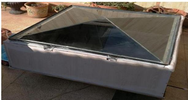
شکل ۶: قرار دادن پوشش شیشه‌ای روی حوضچه
