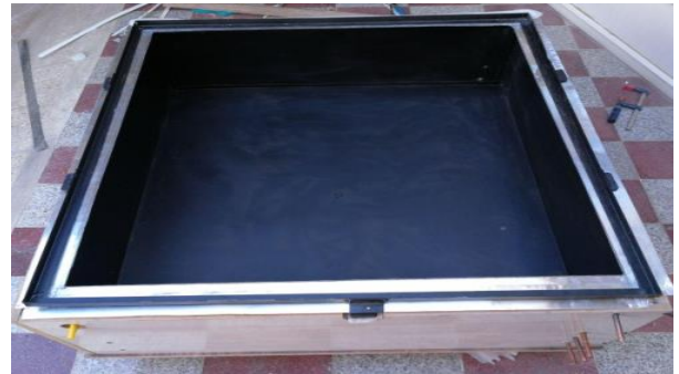
شکل ۱: حوضچه آب شور پس از رنگ آمیزی، عایق کاری و قرار گرفتن در باکس ام دی اف
