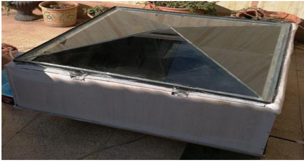
شکل ۶: قرار دادن پوشش شیشه ای روی حوضچه
