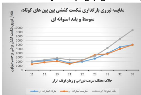
تصویر ۴: مقایسه‌ی نیروی شکست کششی برشی بین‌های کوتاه، متوسط و بلند
