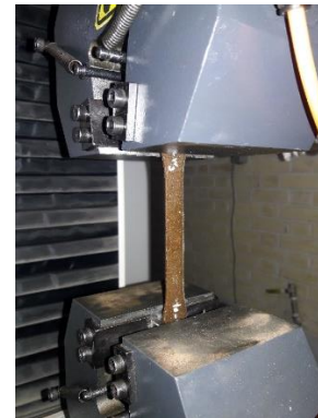
شکل ۷: نمونه تحت آزمون کشش
