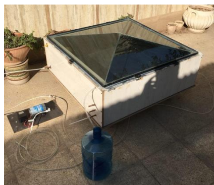
شکل ۱: تصویر واقعی دستگاه آب شیرین کن خورشیدی
