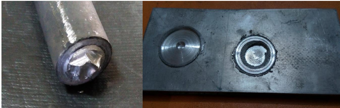
شکل ۱۷- جدا شدن منطقه‌ی اغتشاشی و چسبیدن آن به پین ابزار بدلیل سرعت زیاد نشستن ابزار بر روی صفحات
