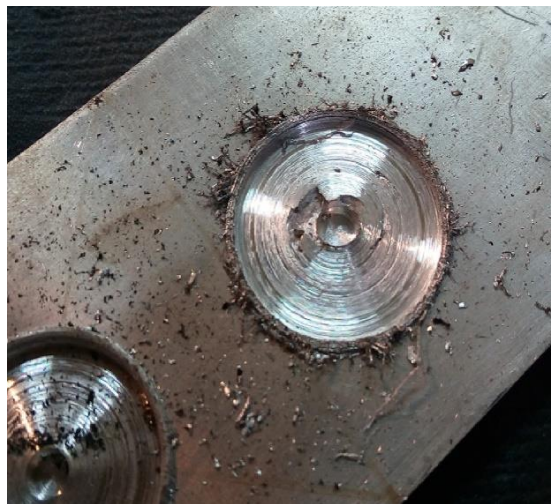
شکل ۱۶- منطقه‌ی اغتشاشی نامناسب که وجود برخی ناخالصیها و مواد زائد، بر روی صفحات یا پین ابزار را نشان می‌دهد
