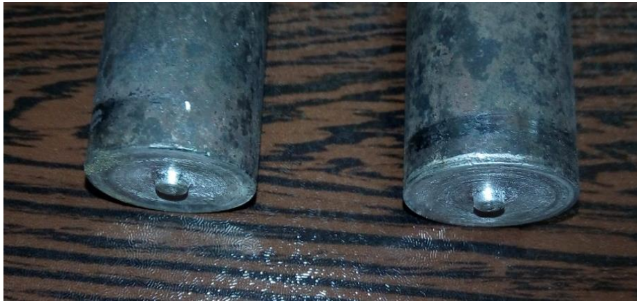
شکل ۲- نمایی از پین‌های کوتاه تراشیده شده: سمت چپ پین مخروطی و سمت راست پین استوانه‌ای
