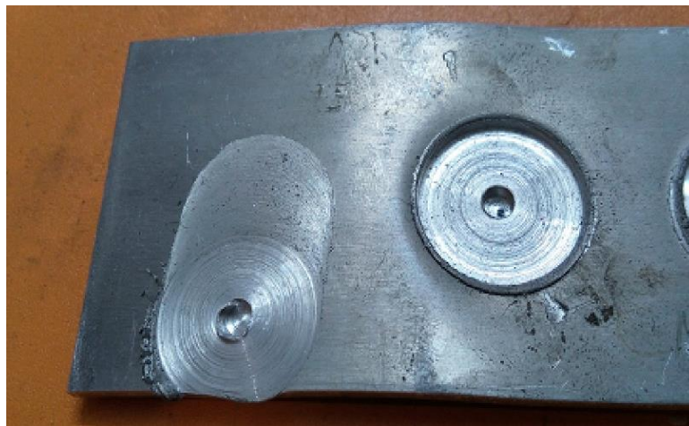
شکل ۱۵- حرکت کردن صفحه در هنگام فرود آمدن ابزار و در نتیجه خراب شدن جوش زده شده
