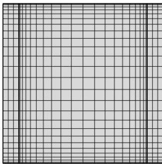
شکل ۴: شبکه بنده محفظه مربعی با اندازه  $25 \times 25$
