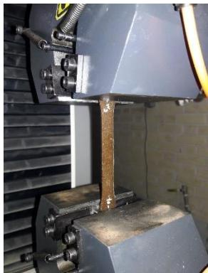
شکل ۷: نمونه تحت تست کشش
