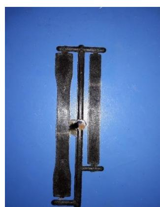
شکل ۶: نمونه تولید شده از ترکیب باگاس و پلیپروپیلن
