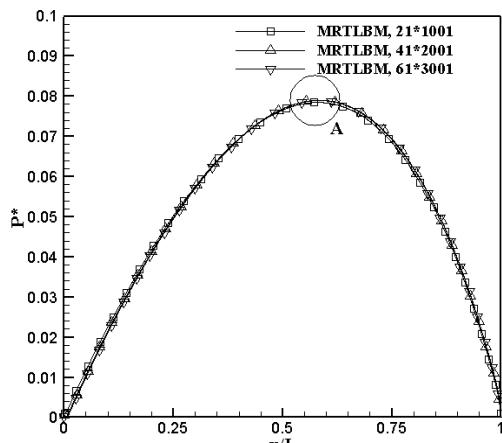
شکل ۱۱ بی بعد شده‌ی انحراف فشار از توزیع فشار خطی برای عدد نادسن  $0/053$  و نسبت فشار  $2/02$
