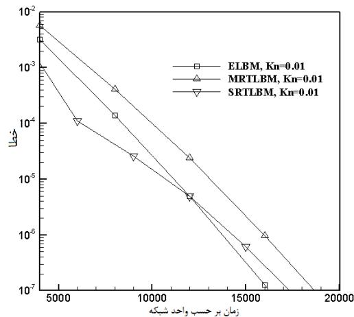
شکل ۶ خطای نسبی توزیع سرعت در یک میکروحفره برای  $Kn=0.01$
