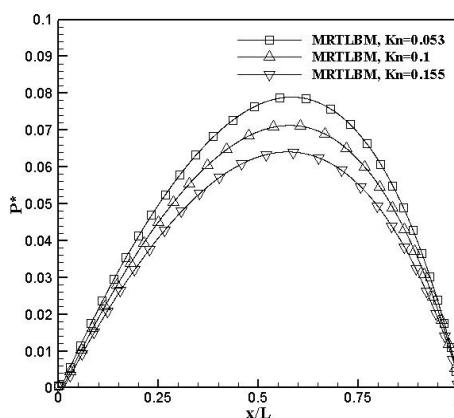
شکل ۱۶ بی بعد شدهٔ انحراف فشار از توزیع فشار برای اعداد نادسن مختلف و نسبت فشار  $2/0\cdot2$
