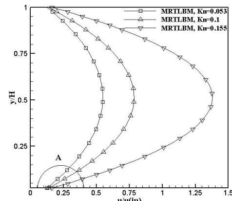
شکل ۱۴ توزیع سرعت بی بعد شده در امتداد خط مرکزی میکروکانال برای اعداد نادسن مختلف و نسبت فشار  $2/0\cdot2$
