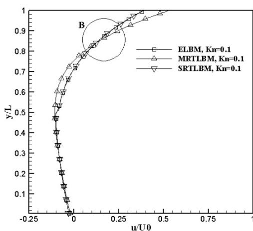
شکل ۸ مولفه‌ی  $x$  سرعت در امتداد خط مرکزی عمودی میکروحفره برای  $Kn = 0.1$
