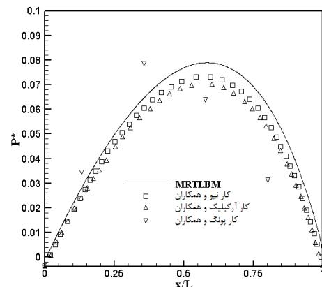
شکل ۱۳ بی بعد شدهٔ انحراف فشار از توزیع فشار خطی برای عدد نادسن  $2/0\cdot2$  و نسبت فشار  $0/0\cdot53$
