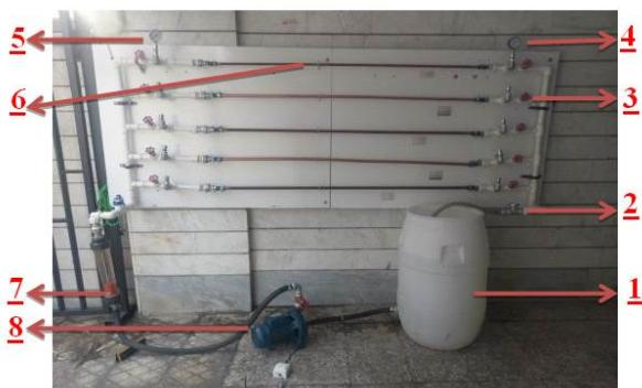
شکل ۳ سیم آزمایشگاهی اندازه گیری افت فشار
