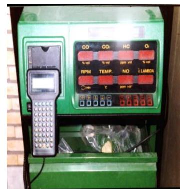
شکل ۴: دستگاه اندازه‌گیری آلاینده‌های موتور
