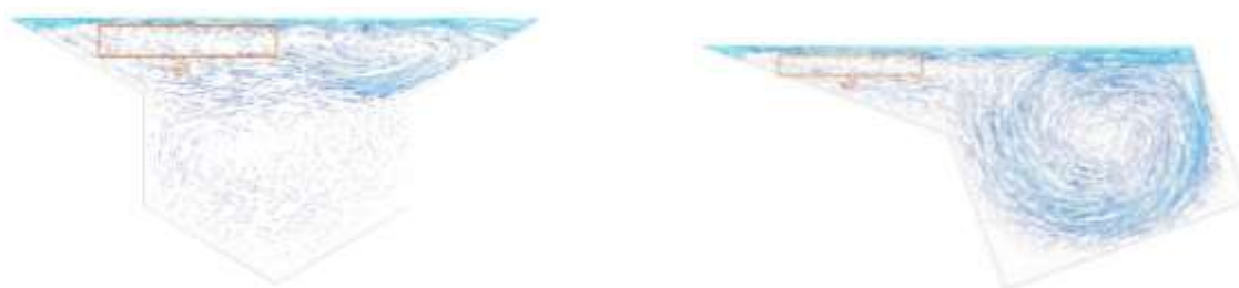
شکل ۱۲: نمایش لایه برشی در میدان جریان داخل ریبلت در هندسه های ۱ و ۴
