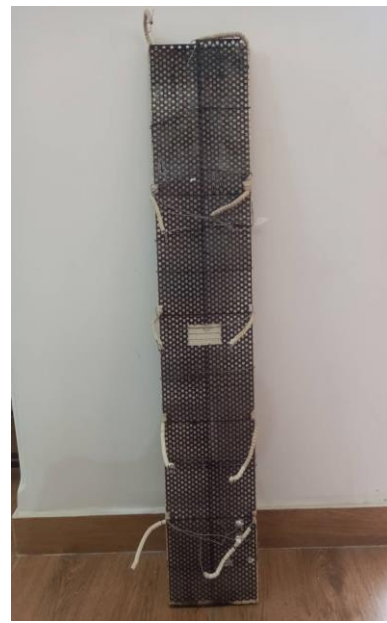
شکل ۱۰-المنت سرامیکی چسبیده به صفحه مشبک فلزی
