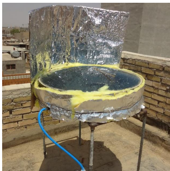
شکل ۲- آب شیرین کن خورشیدی همراه با متمرکز کننده
