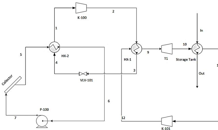
شکل ۲: وضعیت فرآیندی سیستم تولید آب گرم کارخانه
