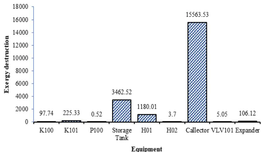
شکل ۵: تخریب اکسرژی کلیه تجهیزات
