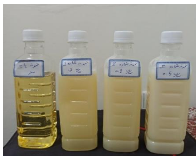
شکل ۳- مراحل پراکنده شدن نانوذرات در نانو روانکار به وسیله دستگاه آلتراسونیک.
