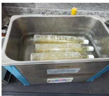
شکل ۳- مراحل پراکنده شدن نانوذرات در نانو روانکار به وسیله دستگاه آلتراسونیک.
