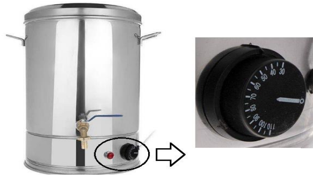
شکل ۲: سیستم تأمین گرما با دمای کنترل شده
