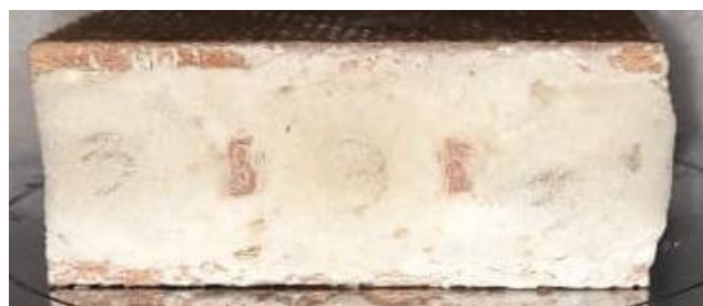
شکل ۵: نمونه نهایی از ساندویچ پانل ساخته شده الیاف کولار همراه با فوم
