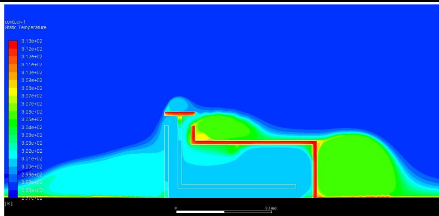
شکل ۲۱: کانتورهای دما در سرعت باد ۸ متر بر ثانیه
