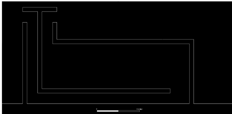
شکل ۱۲: هندسه مد نظر برای ارتفاع بادگیر ۴/۵ متر
