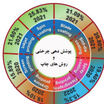
شکل ۳: مقایسه کلی از بالاترین بازده‌های سلول‌های خورشیدی پروسکایت تولید شده از روش‌های مختلف چاپ و پوشش‌دهی چرخشی
