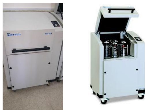
شکل ۲: دستگاه آسیای مکانیکی سیاره‌ای
