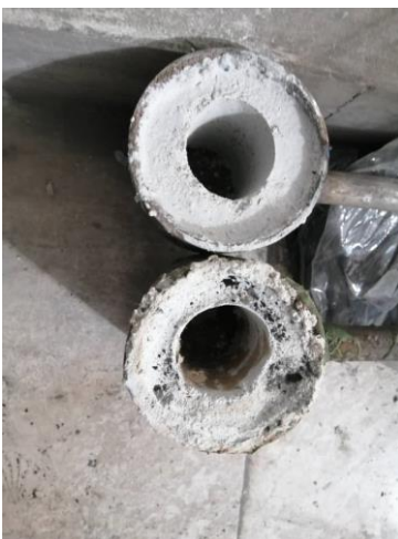
شکل ۵: تهیه بوته برای نمونه حاوی ۲۰ درصد زیرکونیا
