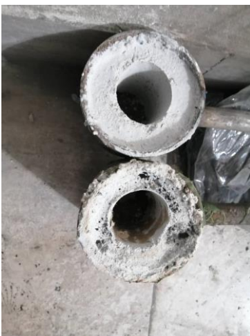
شکل ۵: تهیه بوتله برای نمونه حاوی ۲۰ درصد زیرکونیا
