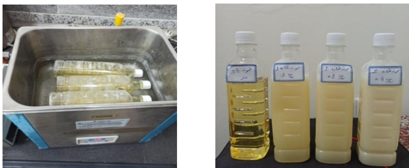
شکل ۳: مراحل پراکنده شدن نانوذرات در نانو روانکار به وسیله دستگاه آلتراسونیک.
