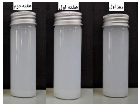
شکل ۴: تست پایداری نانوسیالات در غلظت ۲٪ جرمی
